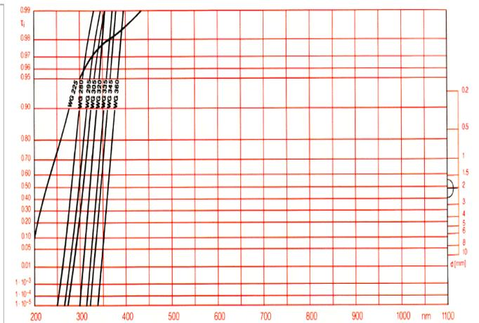
(d) WG360 filter transmission curve (from KPNO).
